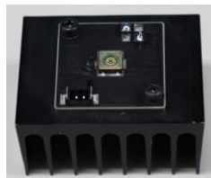
照片 9 让鳍片向下设置 (妨碍空气流动的朝向)
