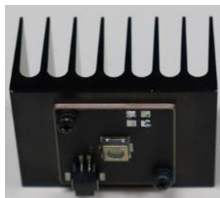
照片 8 让鳍片向侧面设置 (日亚设置朝向)
